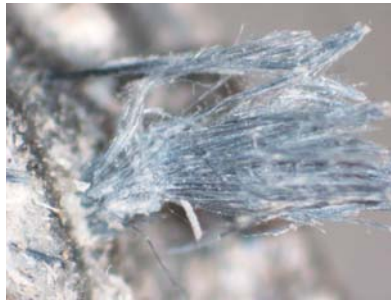
Figura A1.4 Material con amianto CROCIDOLITA (60 X)
