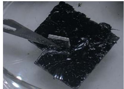
Figura A1.9 Material NO FRIABLE (tela asfáltica)
