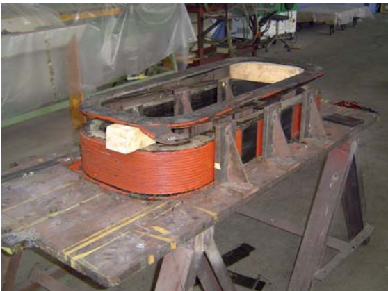
Figura A1.35 Aislamientos eléctricos en una bobina
