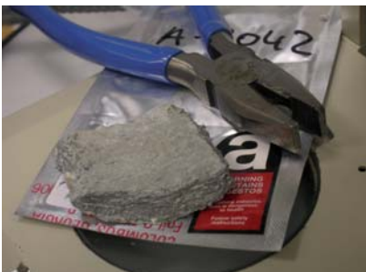
Figura A1.8 Material NO FRIABLE (fibrocemento)
