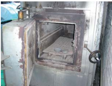
Figura A1.32 Junta textil en un horno
