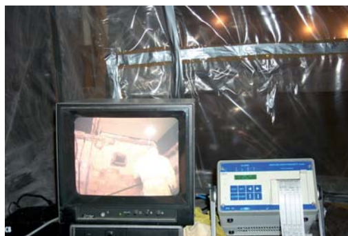
Figura A3.11 Medidas adicionales para el control de la eficacia de la burbuja
