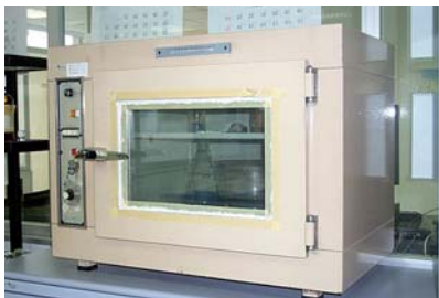
Figura A1.41 Junta aislante en la puerta de una estufa de secado
